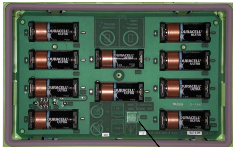
Figure 8 : Compartiment des piles
